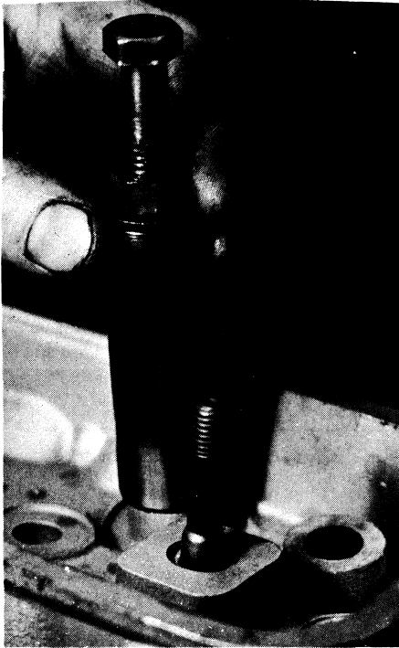
Extracción de una guía de válvula con tornillo pasante largo, rondana, tuerca y abrazadera de muñeca
