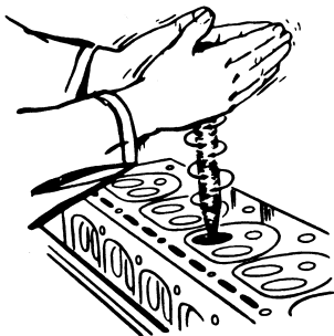
Asentado manual de las válvulas
